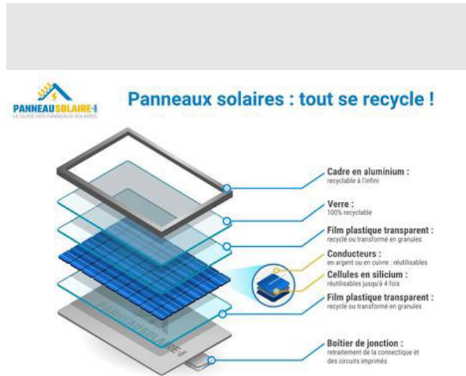
Figure 54 : Les modalités de recyclage des panneaux solaires
