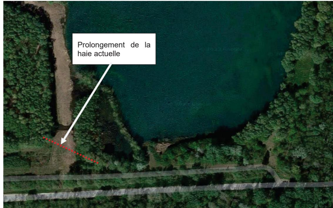
Figure 5-1 : Recommandations vis-à-vis du risque d'embâcles relatives à la haie située en amont de la gravière
