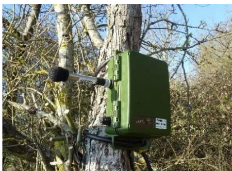
Photo 32 : Détecteur d'ultrasons utilisé lors de l'étude
