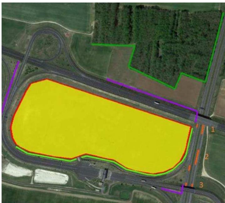
Zones de la trajectoire sur l'A77 impactés par des rayons réfléchis
