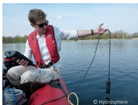
Figure 101 : Relevés physico-chimiques à la sonde multi-paramètres (source : Ecosphère, 2023)
