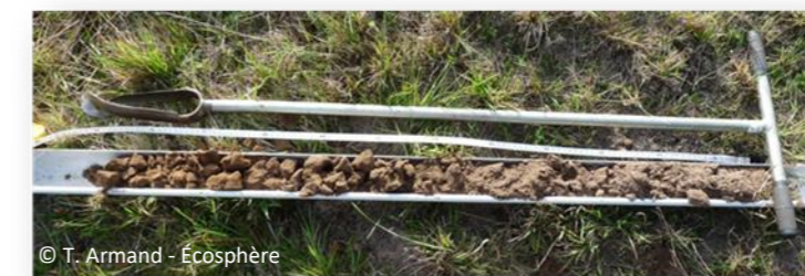
Sondage pédologique à la tarière manuelle
