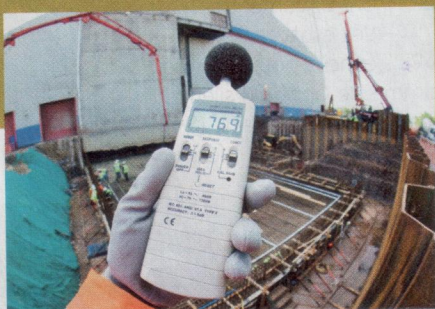
Sonomètre pour mesurer le bruit au travail.
