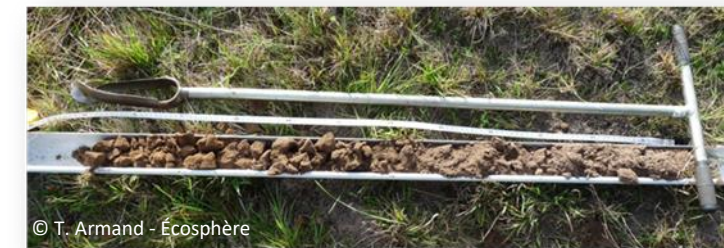
Sondage pédologique à la tarière manuelle
