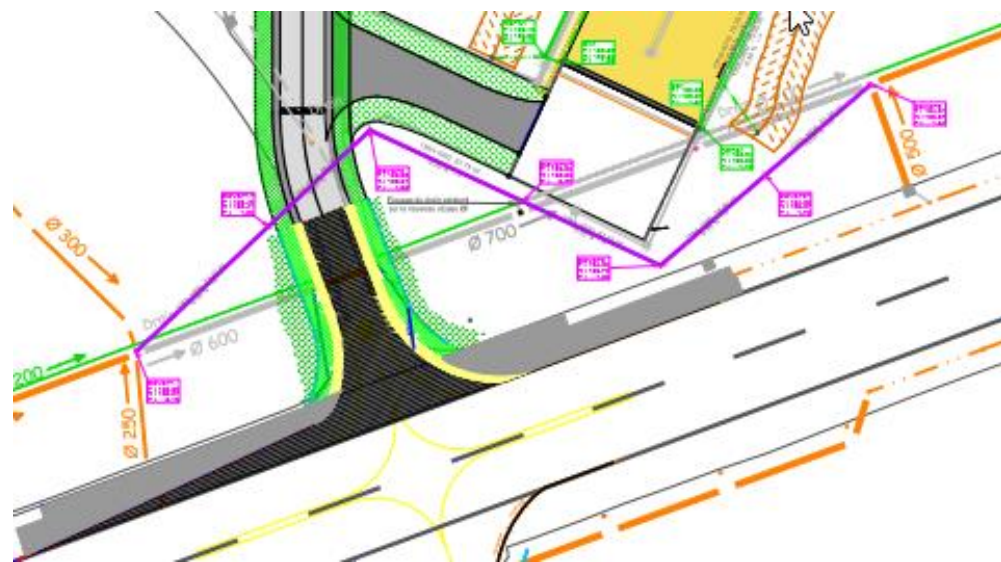
Figure 11 : Plan des travaux de dévoiement
