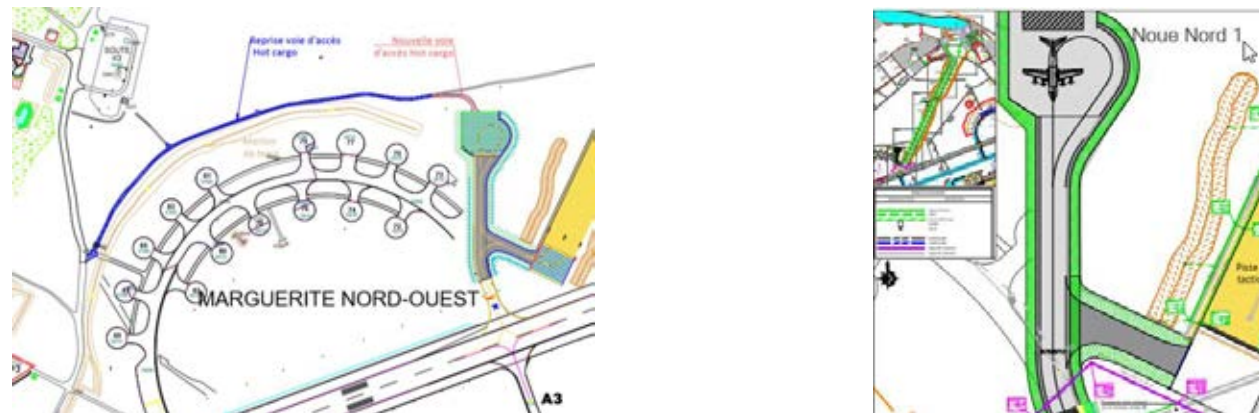
Figure 13 : Aire de stationnement Hot Cargo, voie d'accès poids-lourds et bretelle N3
