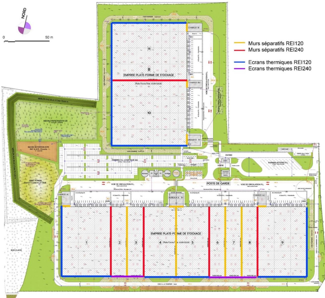
Figure 4 : Positionnement des parois séparatives et écrans thermiques
