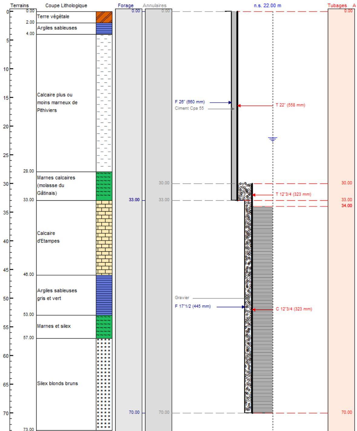
Figure 3 : Coupe géologique et technique du forage définitif F3
