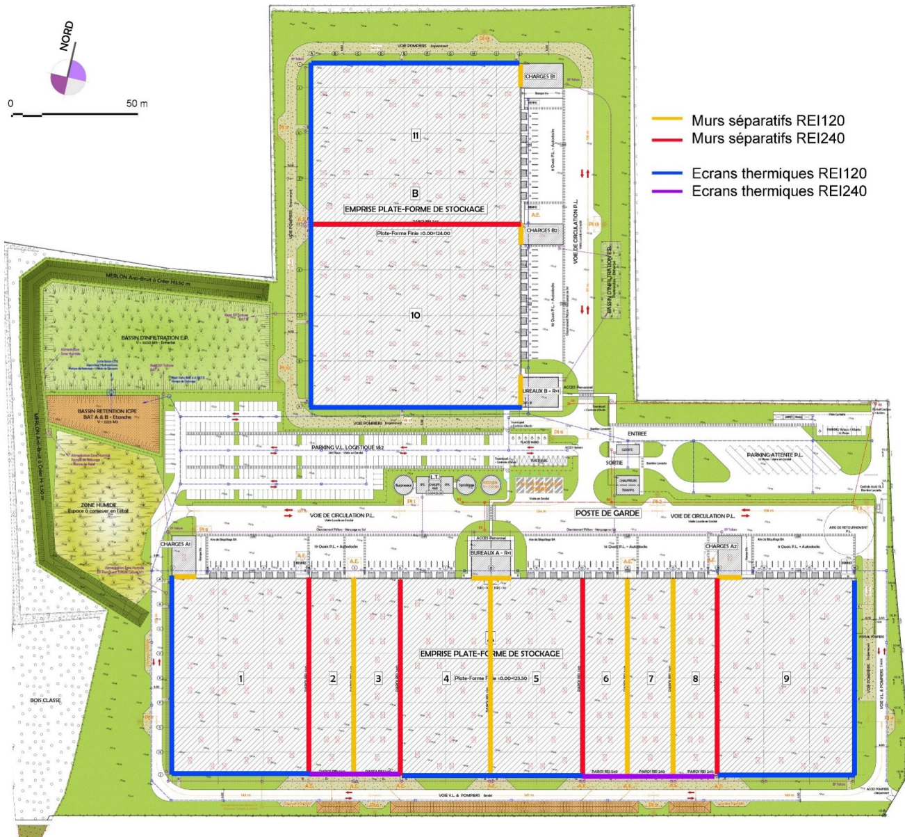
Figure 4 : Positionnement des parois séparatives et écrans thermiques
