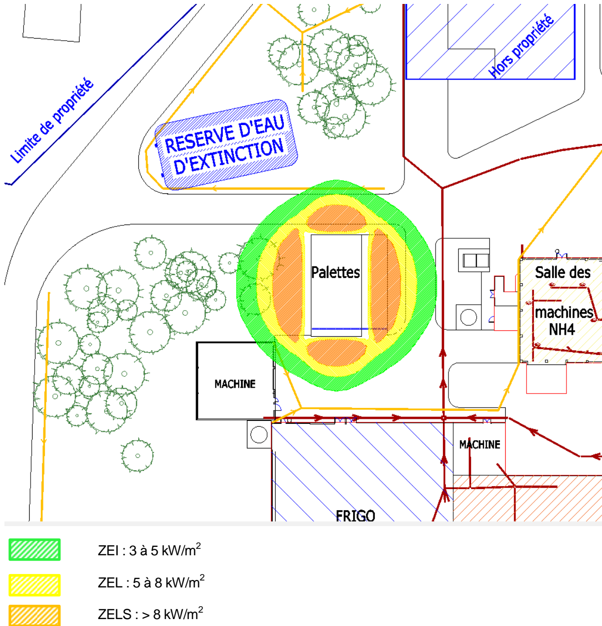
Figure 6: Flux thermiques dus à l'incendie du stockage de palettes
